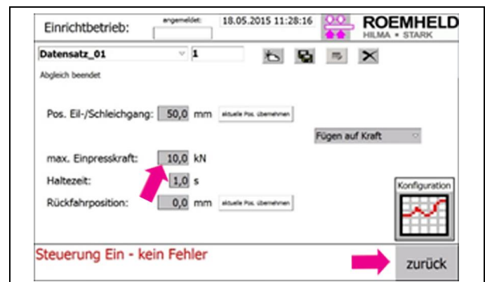
Abb. 25: Anzeige Parametereingabe bei Steuerungsvariante 1 und 2
