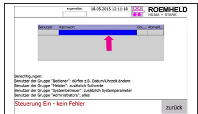
Abb. 11: Anzeige des Touch Panels zur Kennwortänderung
