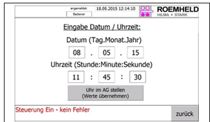
Abb. 17: Anzeige des Touch Panels beim Ändern des Systemsdatums
