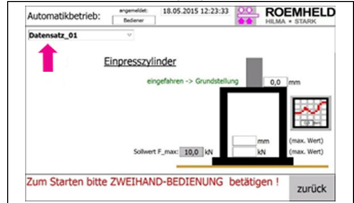
Abb. 28: Automatikbetrieb mit Datensatzauswahl und Statusanzeige
