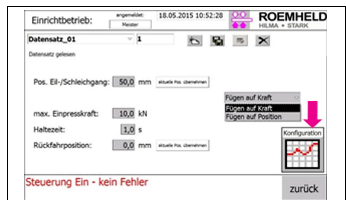
Abb. 22: Anzeige Paramatereingabe Steuerungsvariante 1 und zur Konfiguration Steuerungsvariante 2
