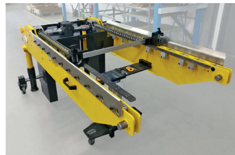
Vista de la cadena de tracción y de empuje y el adaptador de troquel
