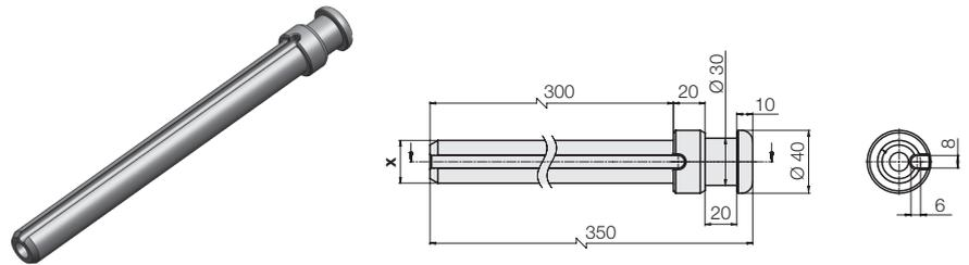
Spanndorn  $x = \varnothing 27,2$  mm
