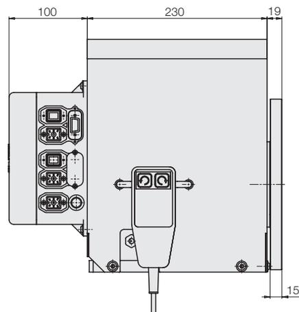
Modulo di rotazione montato all'attrezzatura di montaggio *moduLift* secondo tabella di catalogo M 9.103
